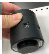
図2 振動式スピーカーの例
