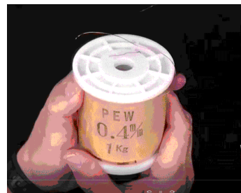
図5 直径が 0.4mm の マグネットワイヤー
