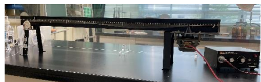
図5 弦の定常波の実験器
